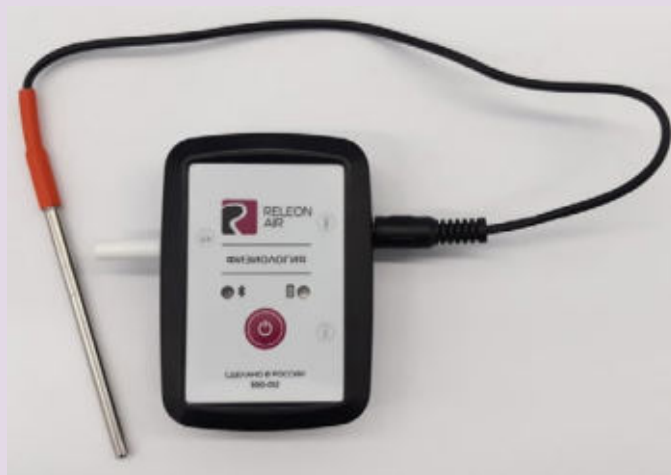
Рис. 12. Датчик температуры тела
