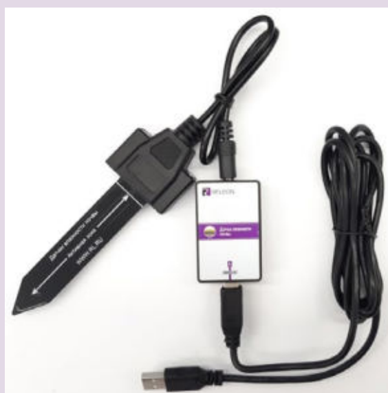
Рис. 4. Датчик влажности почвы
