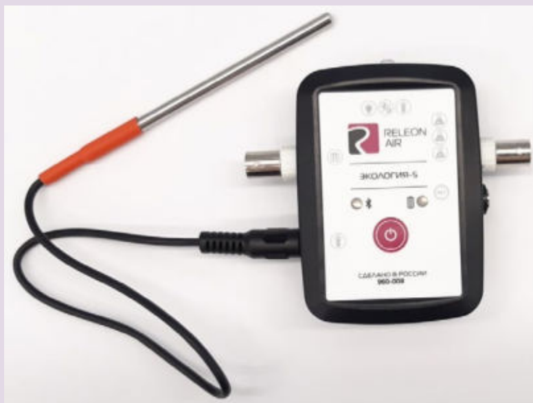
Рис. 6. Датчик температуры растворов
