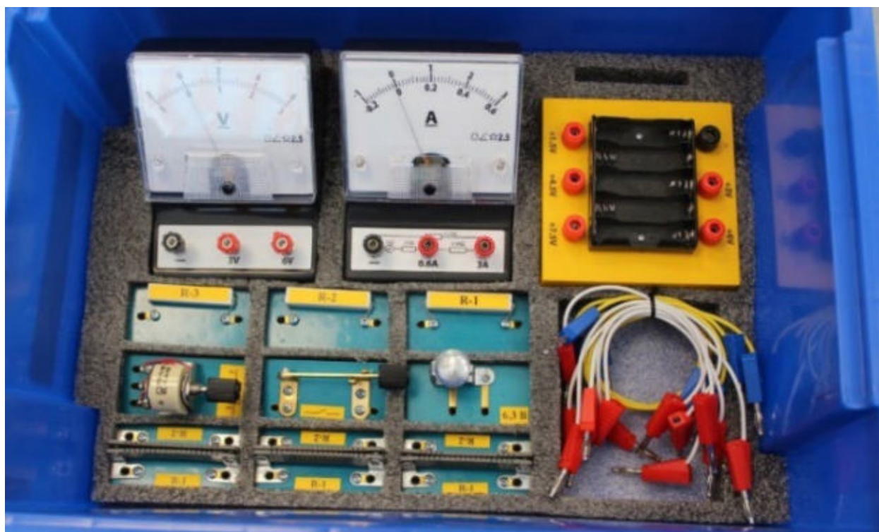
Рис. 2. Оборудование комплекта для проведения экспериментов по электродинамике
