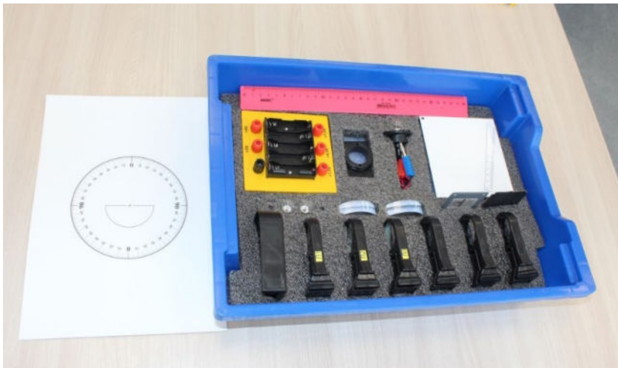
Рис. 1. Оборудование комплекта для проведения экспериментов по оптике
