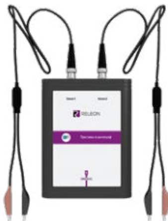
Рис. 1. Двухканальная приставка-осциллограф Releon
